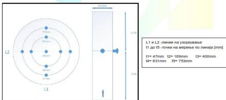
Слика бр. 4: Графички приказ на мерна рамнина со мерни линии и мерни точки – Котел 1
